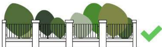
Oszlopos kerítés 1/3-ad lábazat és 2/3-ad áttört részzel.
